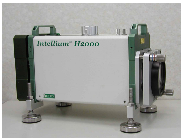
写真 12.4 H-2000 瞬間位相シフトフィゾー干渉計 外観
