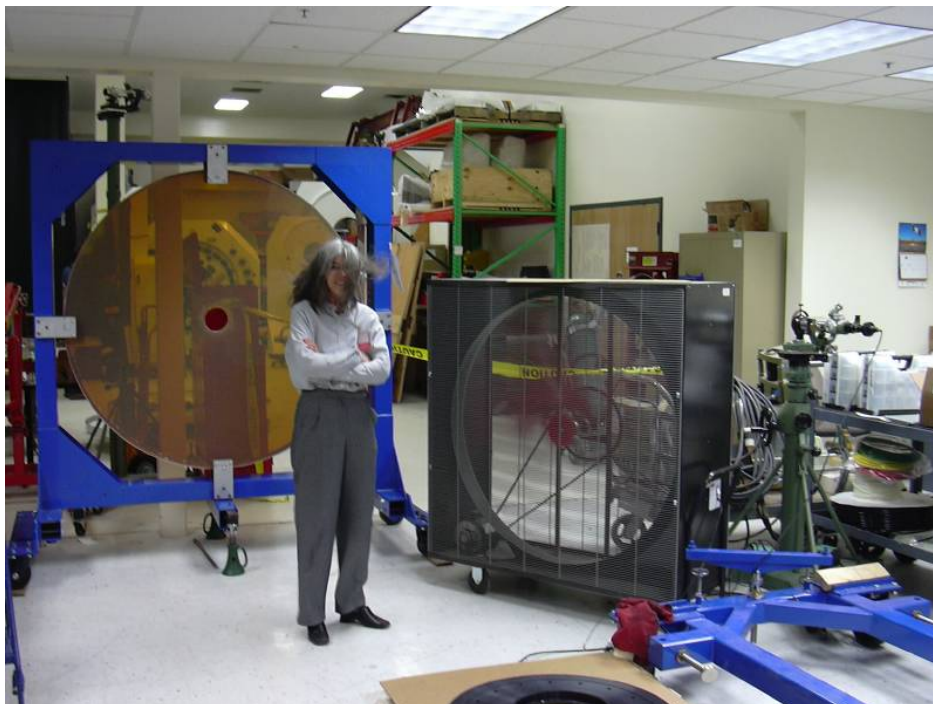
写真 12.6 \phi 1.5\text{M} 凹面ミラーと空気気流制御用大型扇風機
