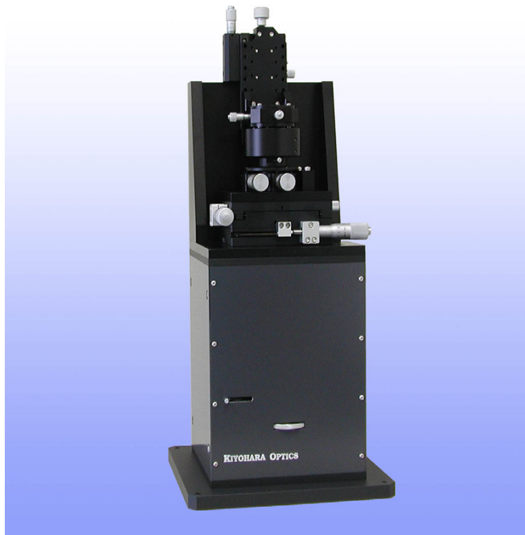
写真 12.1 小型位相シフト干渉計（トワイマン・グリーン型）
